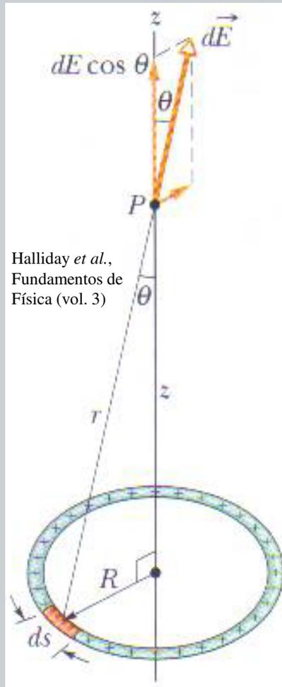
Calcule o campo elétrico gerado no ponto  $P$  por uma carga  $q$  distribuída uniformemente ao longo de um anel de raio  $R$ , conforme mostra a figura ao lado.
