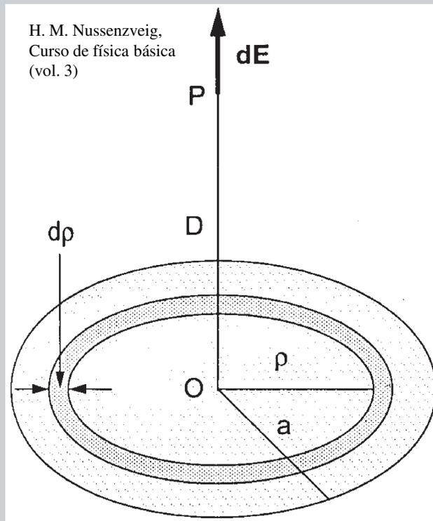
Neste cálculo vamos considerar que o disco é formado por infinitos anéis concêntricos. Vamos aplicar o **1º passo** para um destes anéis que possui carga  $dQ$  (região sombreada da figura ao lado). O campo é dado pela equação (7):
