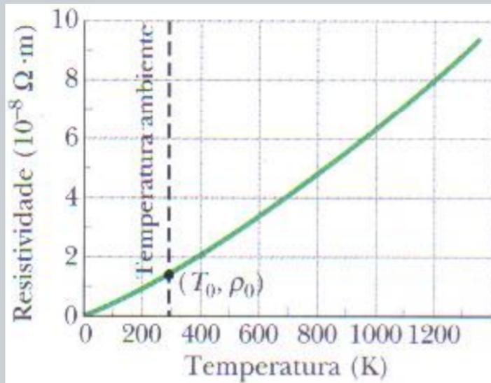
Em uma ampla variedade de materiais, a resistividade elétrica varia, com boa aproximação, linearmente com a temperatura:
