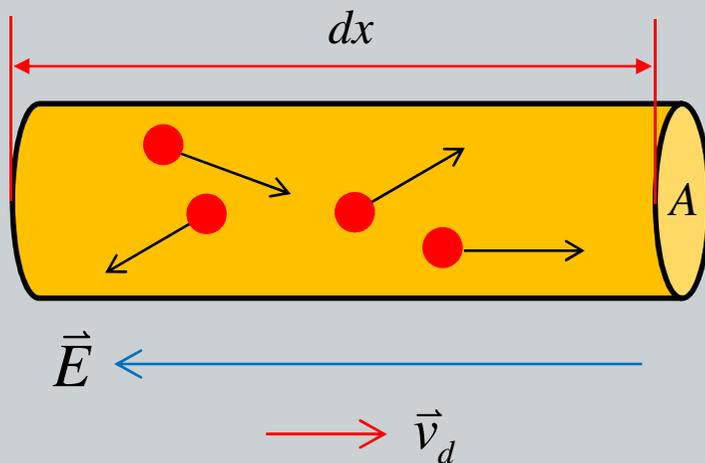
Considerando que a densidade volumétrica de partículas carregadas dentro do condutor é  $n$  e a região analisada possui volume  $dV = Adx$ , em que  $dx$  é o comprimento percorrido pelas partículas e  $A$  a área da seção reta, o número total de partículas neste volume é  $nAdx$ . Assim, a carga neste volume será:
