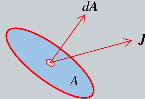
em que  $dA$  é o vetor elemento de área e  $J$  é um vetor que indica a direção do movimento das cargas chamado de **densidade de corrente**. A densidade de corrente mede a quantidade de corrente por unidade de área que atravessa a superfície e sua natureza vetorial permite avaliar a direção da corrente elétrica em um meio material.
