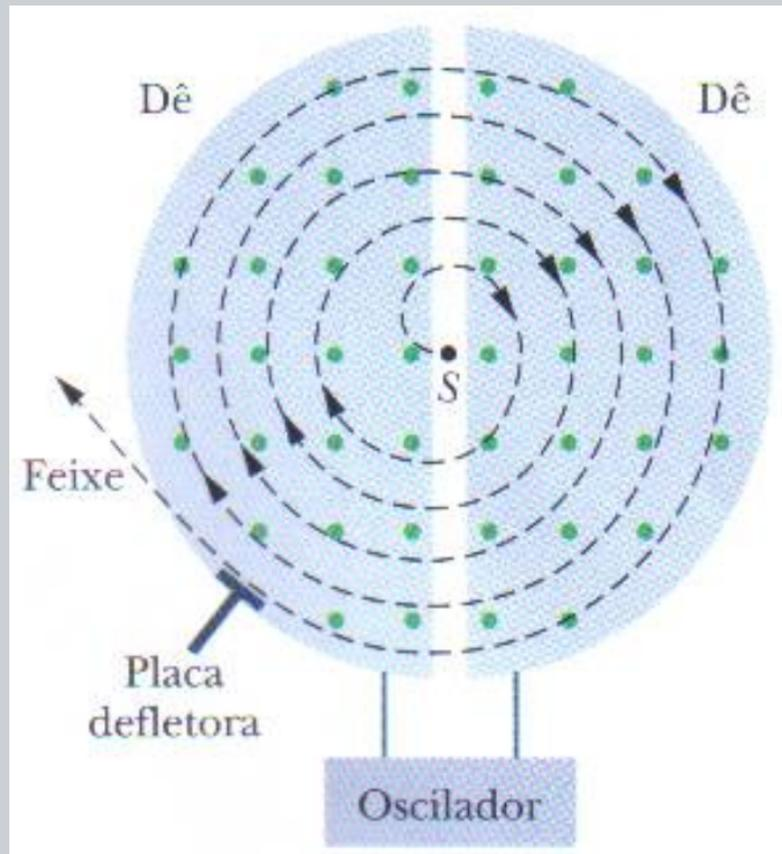
Frequência ciclotrônica:  $f = \frac{|q|B}{2\pi m} = f_{osc}$
