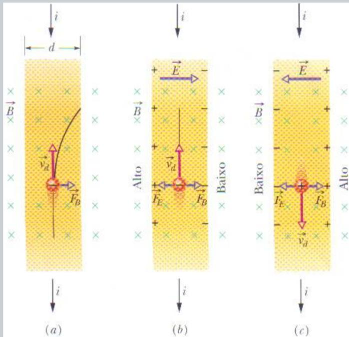
Considere uma fita metálica de largura  $d$  com uma corrente elétrica  $i$  imersa numa região com campo magnético perpendicular ao plano da fita. Na figura (a) os elétrons são deslocados para direita devido a força magnética  $F_B$ .
