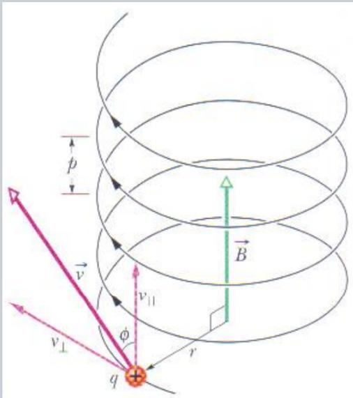
O problema solicita o módulo do vetor velocidade, pois existem duas componentes. Com o módulo da força sobre o elétron e a intensidade do campo magnético, é possível calcular o valor da componente perpendicular com a equação (12):
