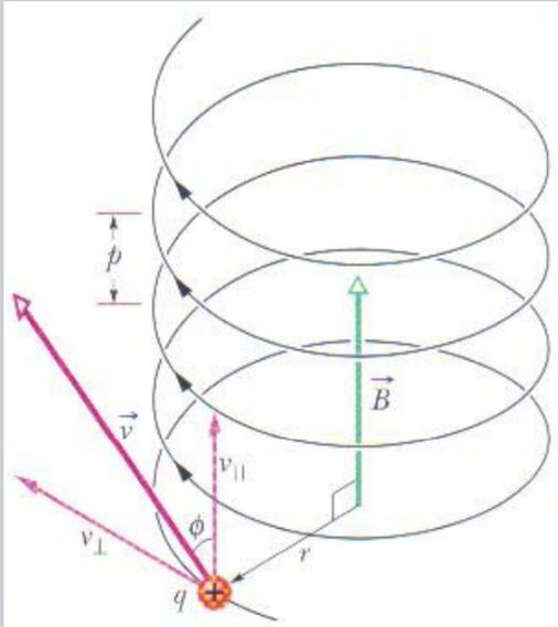
Quando a partícula possui componentes de velocidade perpendicular e paralela ao vetor campo magnético, ela adquire trajetória helicoidal.
